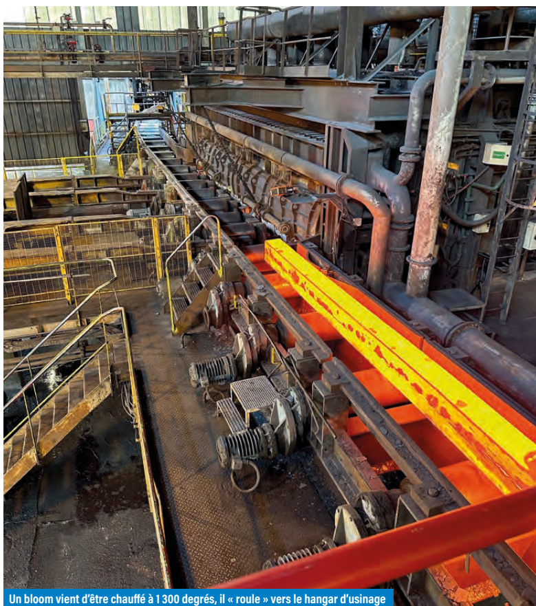
Un bloom vient d'être chauffé à 1 300 degrés, il « roule » vers le hangar d'usinage
