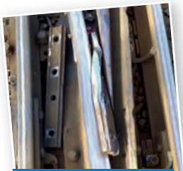
Brétigny, une éclisse est à l'origine du déraillement
