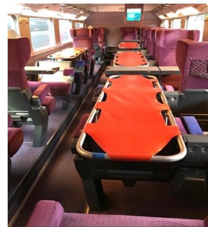
En parallèle, le Technicentre du Landy a modifié de fin mars à début avril, 4 rames TGV Duplex qui seront mises « en configuration sanitaire » en retirant les dossiers des sièges (voir photo), afin que le corps médical puisse y installer les malades, leurs respirateurs équipés de bouteilles d'oxygène mais aussi les personnels de réanimation. Les Clusters travaillent sur la création d'un référentiel de modification des rames TGV en rames sanitaires.
